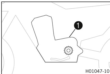
El número del motor ❶ está grabado en la parte superior de la carcasa del motor.
