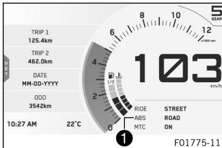
El modo de ABS ajustado se muestra en la zona ❶ del display.
