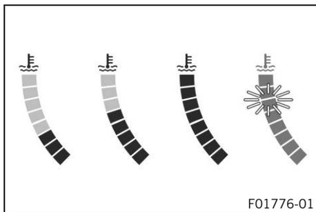
El indicador de la temperatura del líquido refrigerante está compuesto de barras. Cuantas más barras se iluminan, más caliente está el líquido refrigerante. Con una temperatura del líquido refrigerante de 120 °C se activa automáticamente el modo de emergencia.
