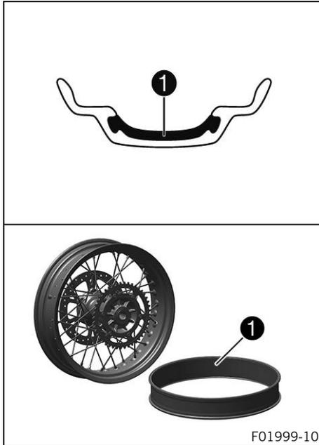
En este vehículo se utiliza un sistema de neumáticos sin cámara en el cual la cámara de aire convencional se sustituye por una goma de sellado de las llantas ①.
