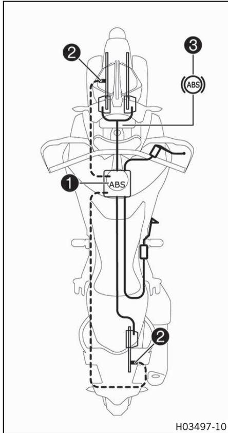
El módulo del ABS ①, compuesto por una unidad hidráulica, una centralita electrónica del ABS y una bomba de recirculación, está instalado debajo del depósito de combustible. Hay un sensor de número de revoluciones de la rueda ② en cada una de las ruedas, la delantera y la trasera.
