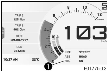
En la zona ❶ del display se indica si **MTC** (📖 pág. 334) está conectado o desconectado. En el submenú **MTC** puede conectarse o desconectarse el control de tracción de la motocicleta.
