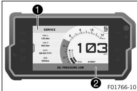
Las advertencias se muestran en el margen superior o inferior del display; en función de la relevancia se resaltan en amarillo o rojo. Las advertencias amarillas ① indican un fallo de funcionamiento o información que requiere tomar medidas rápidamente o adaptar el estilo de conducción.
