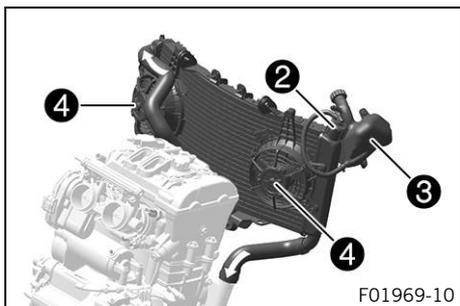
La refrigeración depende de la corriente de aire y de dos ventiladores del radiador **4** que se encienden a altas temperaturas. Cuanto menor sea la velocidad, menor es la acción refrigerante. La suciedad en los nervios del radiador reduce asimismo la acción refrigerante.
