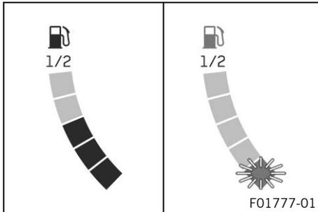
El indicador del nivel de combustible está compuesto de barras. Cuantas más barras estén iluminadas, mayor será el nivel de combustible en el depósito de combustible.
