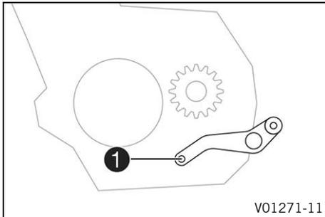
El pedal de cambio **1** está montado en el lado izquierdo del motor.
