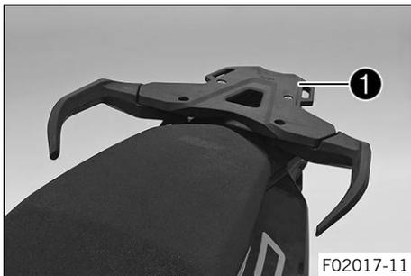
La placa portaequipaje ❶ se encuentra detrás del asiento. La placa portaequipaje permite fijar la placa de montaje de un sistema de maleta (opcional). La placa portaequipaje no se puede cargar con más peso del indicado.
