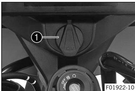
La toma de corriente **1** de accesorios eléctricos se encuentra delante de la tija superior de la horquilla. Está conectada al positivo continuo y protegida con un fusible.
