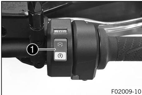
El interruptor de parada de emergencia/botón del motor de arranque ❶ se encuentra en el interruptor combinado derecho.
