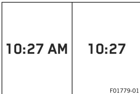
En todos los idiomas, excepto en EN-US, se muestra la hora con el formato de 24 horas. La hora se muestra en formato de 12 horas si está configurado el idioma EN-US.
