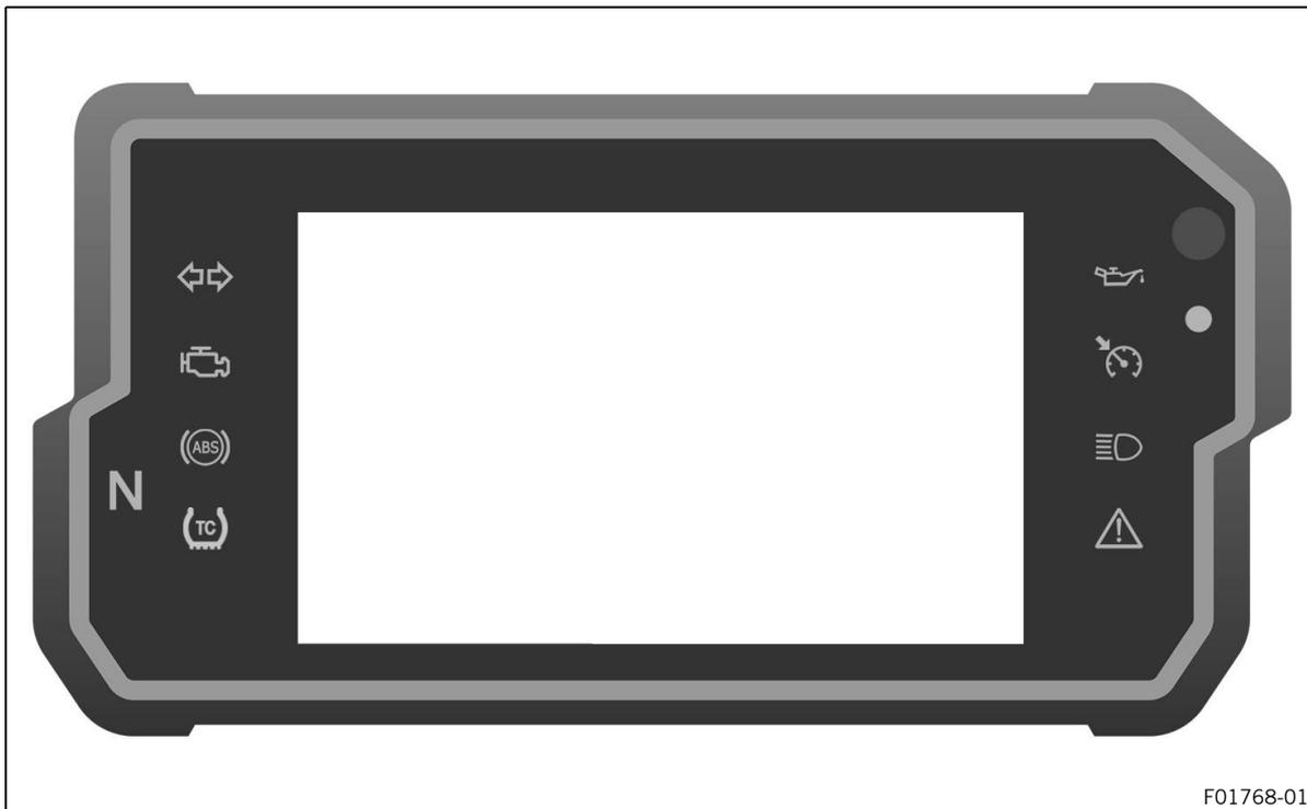
Los testigos de control proporcionan información adicional sobre el estado de servicio de la motocicleta. Al conectar el encendido, se iluminan brevemente todos los testigos de control, excepto el testigo de control TC
